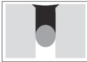
El sellado "a ras" evita riesgos en la circulación y en la acumulación de suciedad de la junta
